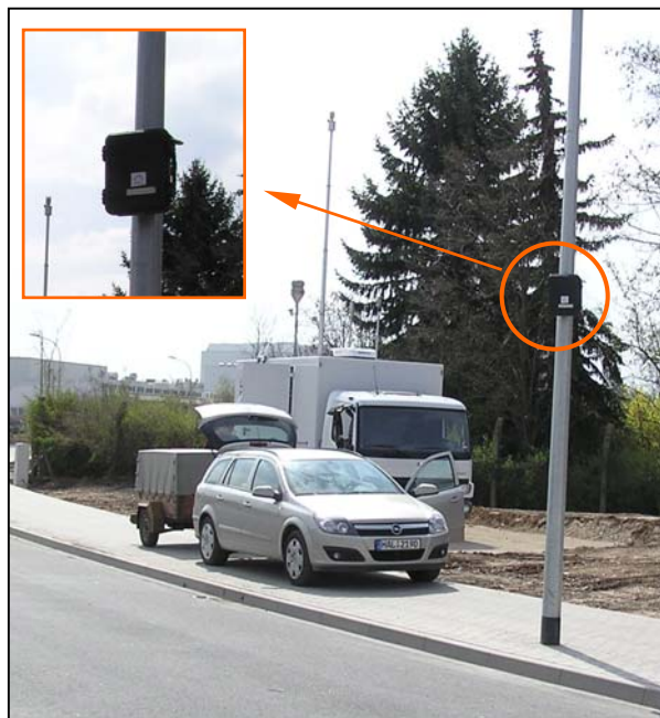
Abbildung 5: SDR-Messsystem zur Verkehrsdatenerhebung an einem Beleuchtungsmast
